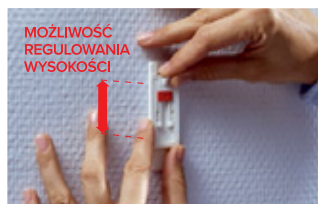
4. Wyreguluj wysokość, a następnie zablokuj nosek gwóźdźa czerwonym suwakiem.
